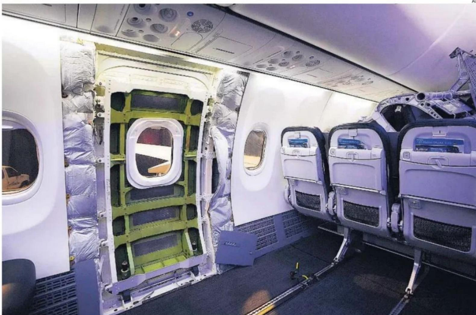
Un boeing de Alaska Airlines perdió una puerta de emergencia y parte del fuselaje en pleno vuelo
